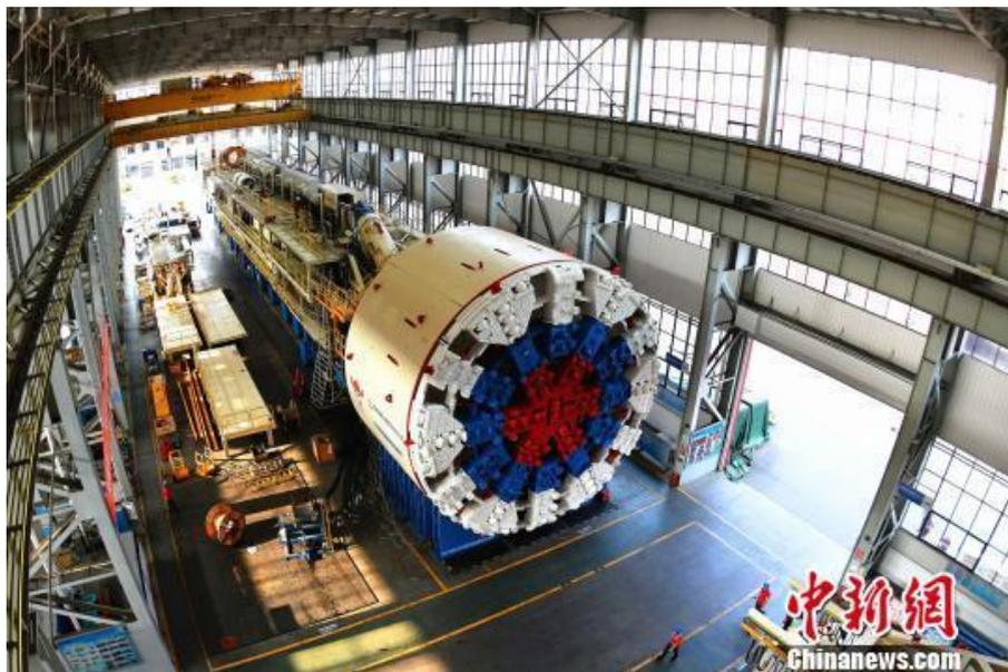
• Компания China Iron Construction Heavy Industries Group отправила в Россию 11-метровый 1700-тонный тоннелепроходческий щит для строительства метро (портал «Чжунго синьвэньван», 27 сентября). Комплекс способен работать при температуре  $-30^{\circ}$ . Это щит с самым большим диаметром среди всех,
